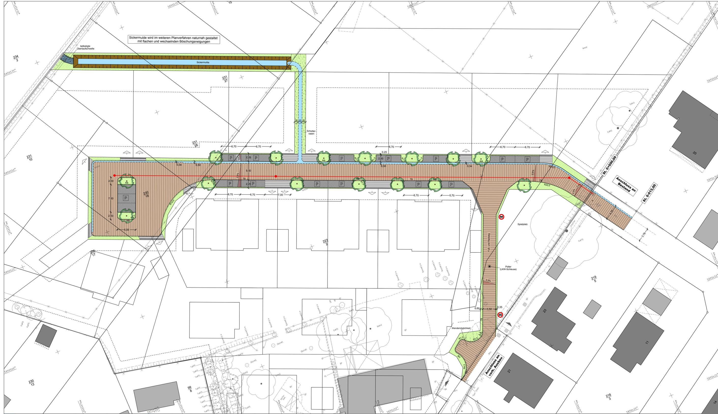
Sickermulde wird im weiteren Planverfahren naturnah gestaltet mit flachen und wechselnden Böschungsneigungen
