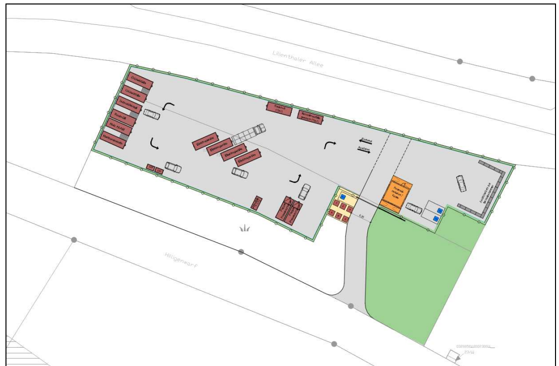
Abb. 6: Konzept des Wertstoffhofes (Quelle: IWA, Ingenieurgesellschaft für Industriebau, Wasser- und Abfallwirtschaft mbH)
